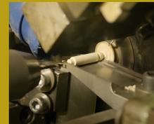
Technique de tournage permettant l'usinage de petites pièces à grande cadence: pions, chevilles, boules...
